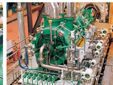
ガスタービン駆動遠心圧縮機 洋上プラットフォーム向け(マレーシア)
