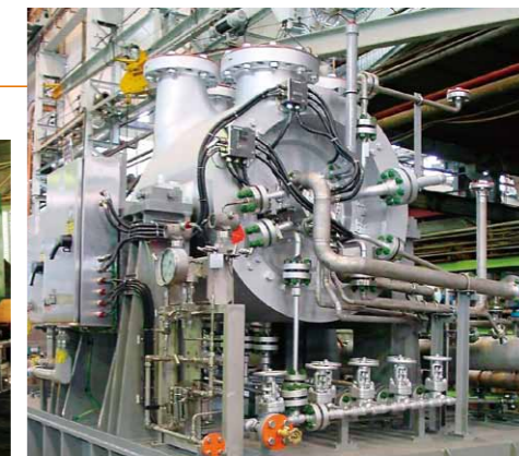
ガスタービン駆動遠心圧縮機 天然ガス処理プラント向け(ナイジェリア)
