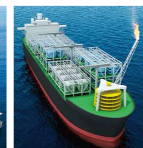
ガスコンプレッションモジュール FPSO向け
