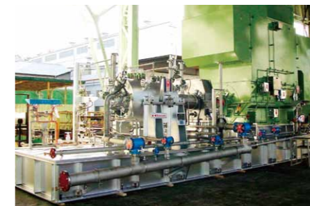
モータ駆動遠心圧縮機 パイプライン向け(サウジアラビア)
