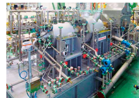
モータ駆動遠心圧縮機 FPSO向け(ベトナム)
