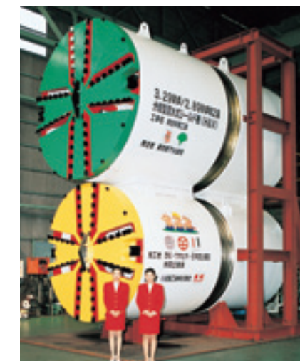
φ3.29m / φ2.89m 縦二連分岐型H&Vシールド
