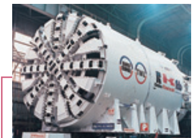
φ8.78mシールド型TBM (英仏海峡海底鉄道トンネル、フランス)
