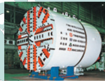
φ6.14m泥土圧シールド (広州地下鉄1号線、中国)
