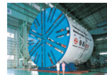
φ10.04m 複線シールド(側部シールド取外し時)
