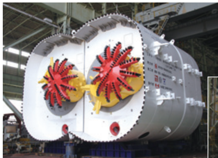
7.44m×10.64m 泥土圧シールド
