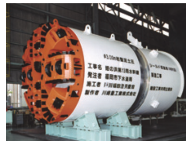
φ3.09m岩盤泥土圧シールド
