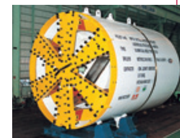
φ6.43m泥土圧シールド(DUAL MODE) (バンコク地下鉄ブルーライン、タイ)
