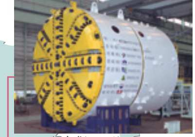
φ7.80m泥水式シールド (ソウル地下鉄9号線、韓国)
