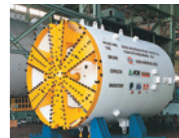
φ5.03m泥土圧シールド (ロンドン地下鉄ジュビリー線、イギリス)
