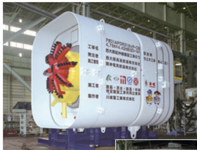
4.76m×4.42m 泥土圧シールド
