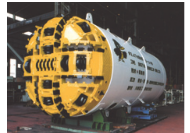
φ2.47m岩盤泥水式シールド
