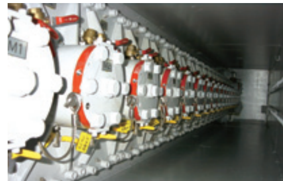
カッタービット交換装置
