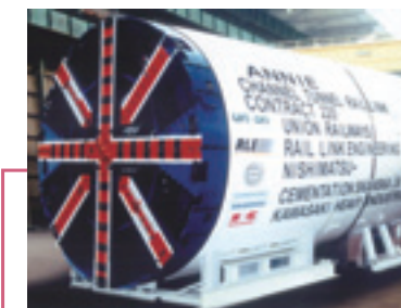
φ8.11m泥土圧シールド(DUAL MODE) (CTRL、イギリス)
