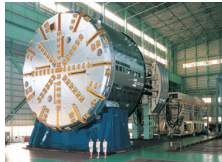
φ12.84m改良オープン型TBM
