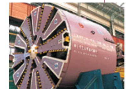
φ6.34m泥土圧シールド (上海地下鉄1号線、中国)
