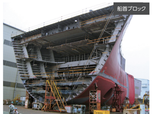
建造中のLNG運搬船
